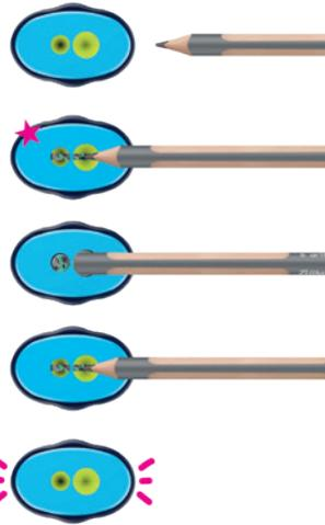
Spezieller Mechanismus öffnet die Spitzlöcher zum Anspitzen, verschließt sich selbstständig wieder und hält den Span sicher im Container
